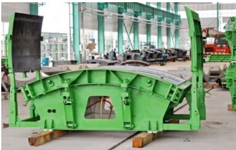
Tübbingschalung für das Projekt Klang Valley MRT in Kuala Lumpur.
